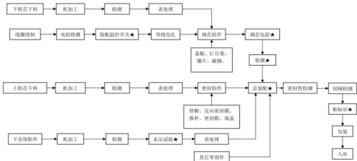
图 4-6 电磁阀生产工艺流程图
